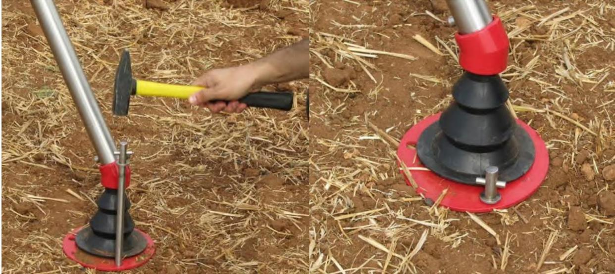
*Figure 37: Inserting Anchors*
