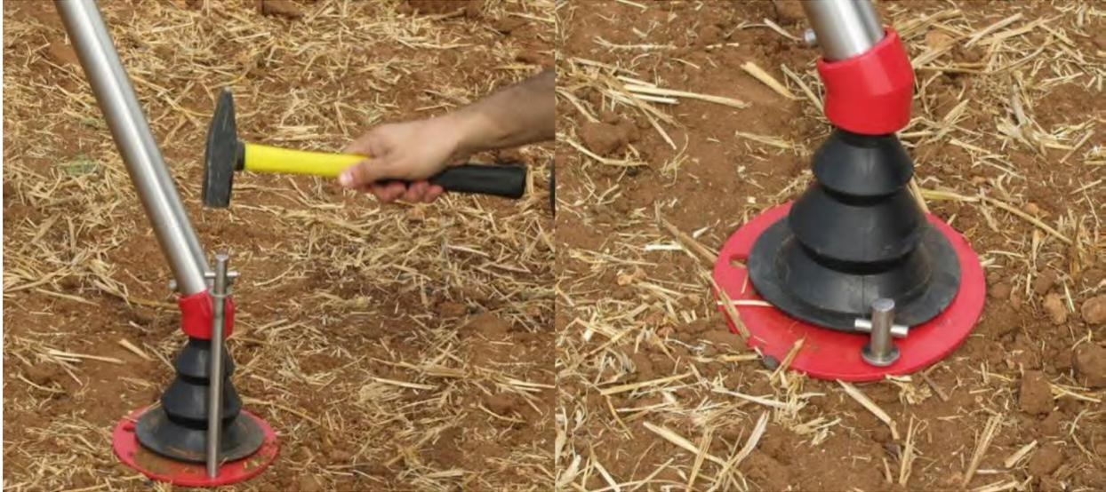
*Figure 37: Inserting Anchors*
